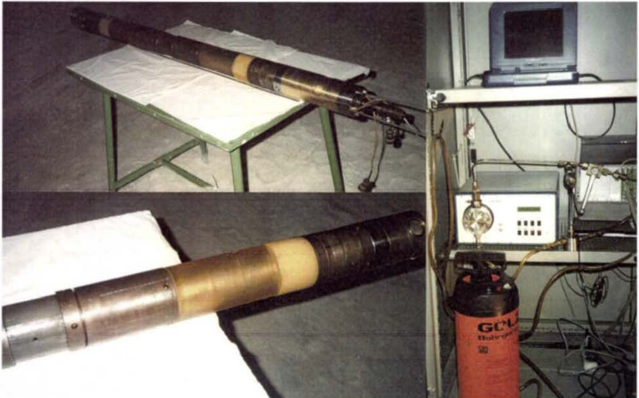
Abbildung 17: Equipment für Spannungssondierungen in Bohrlöchern mit Durchmessern von etwa 101 mm
