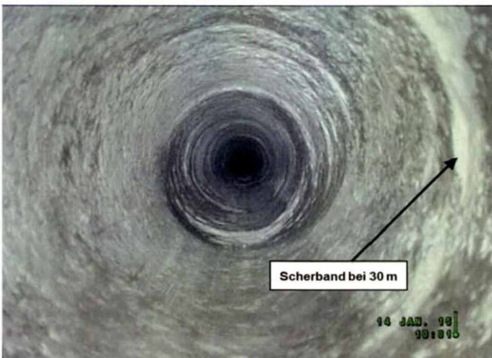
Abbildung 11: Foto aus der Bohrlochkamerabefahrung: Scherband bei Bohrlochteufe 30 m
